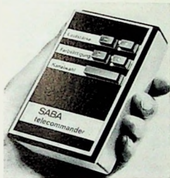
Bild 18. Steuergerät der Ultraschall-Fernbedienung „telecommander“ für das Saba-Farbfernsehgerät „T 3000“
